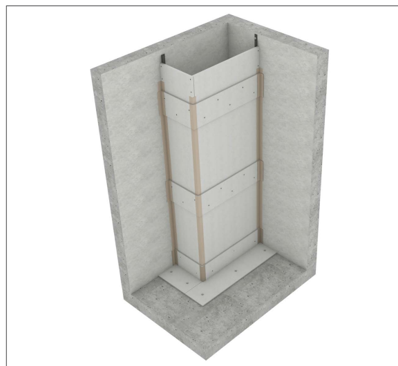
Conducto vertical a dos caras en esquina
