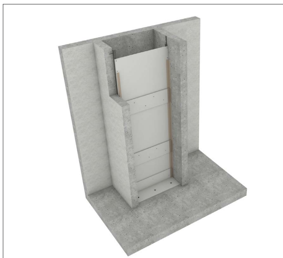
Conducto vertical a una cara encastrado
