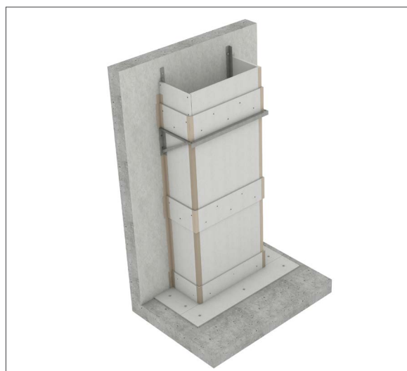
Conducto vertical a tres cara
