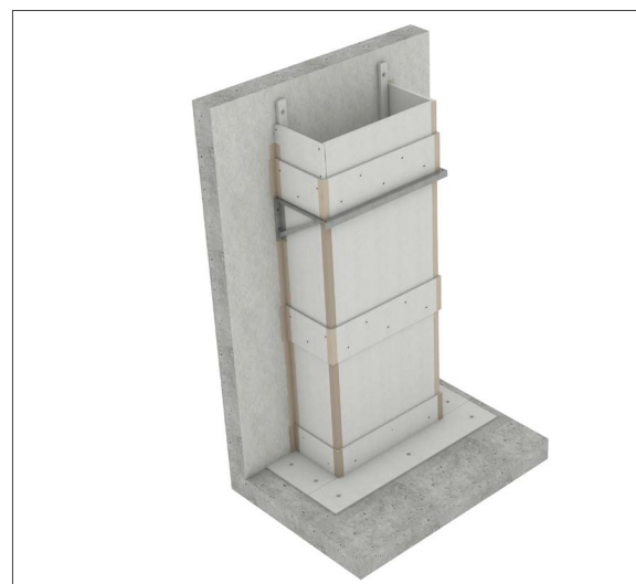
Conducto vertical a tres caras para fuego interior
