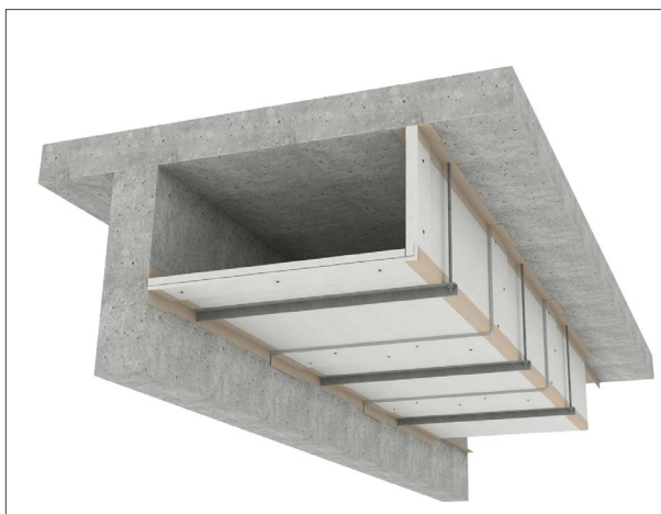
Conducto horizontal a dos caras en esquina con ángulo encastrado en el muro
