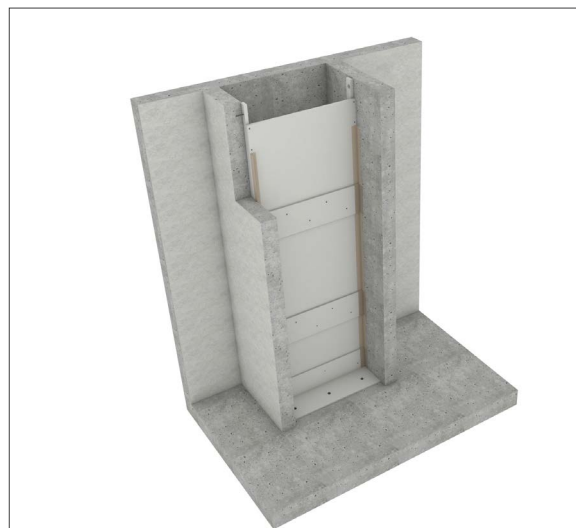
Conducto vertical encastrado a una cara para fuego interior
