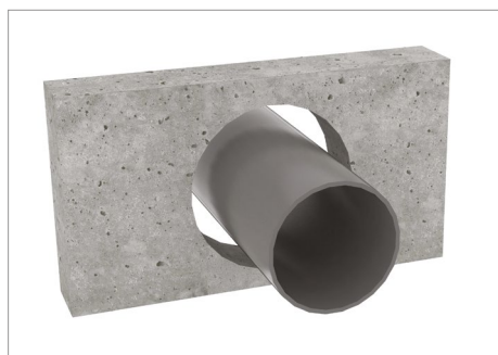
Figura 1: Paso de conducción
