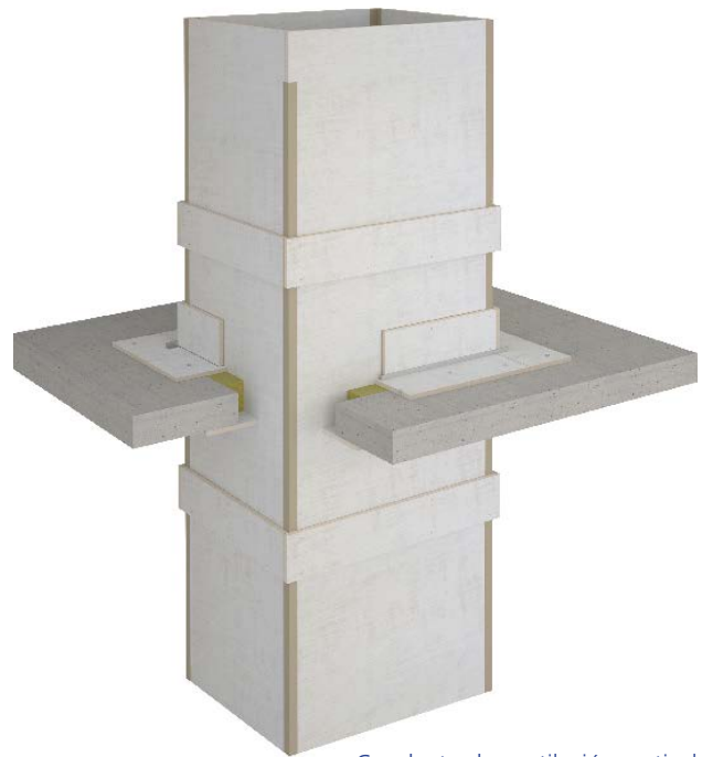
Conducto de ventilación vertical
